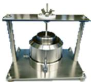
JIS B9915 ダストの見掛け電気抵抗率の測定方法に記載されている二重リング法により、粉体の体積抵抗率 $[\Omega \cdot m]$ 測定に使用する電極です。
