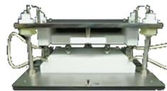
JIS K6271 : 2001 加硫ゴム及び熱可塑性ゴム-体積抵抗率 $[\Omega \cdot m]$ 及び表面抵抗率 $[\Omega / sq]$ の求め方に準拠した、4端子構造の電極です。
